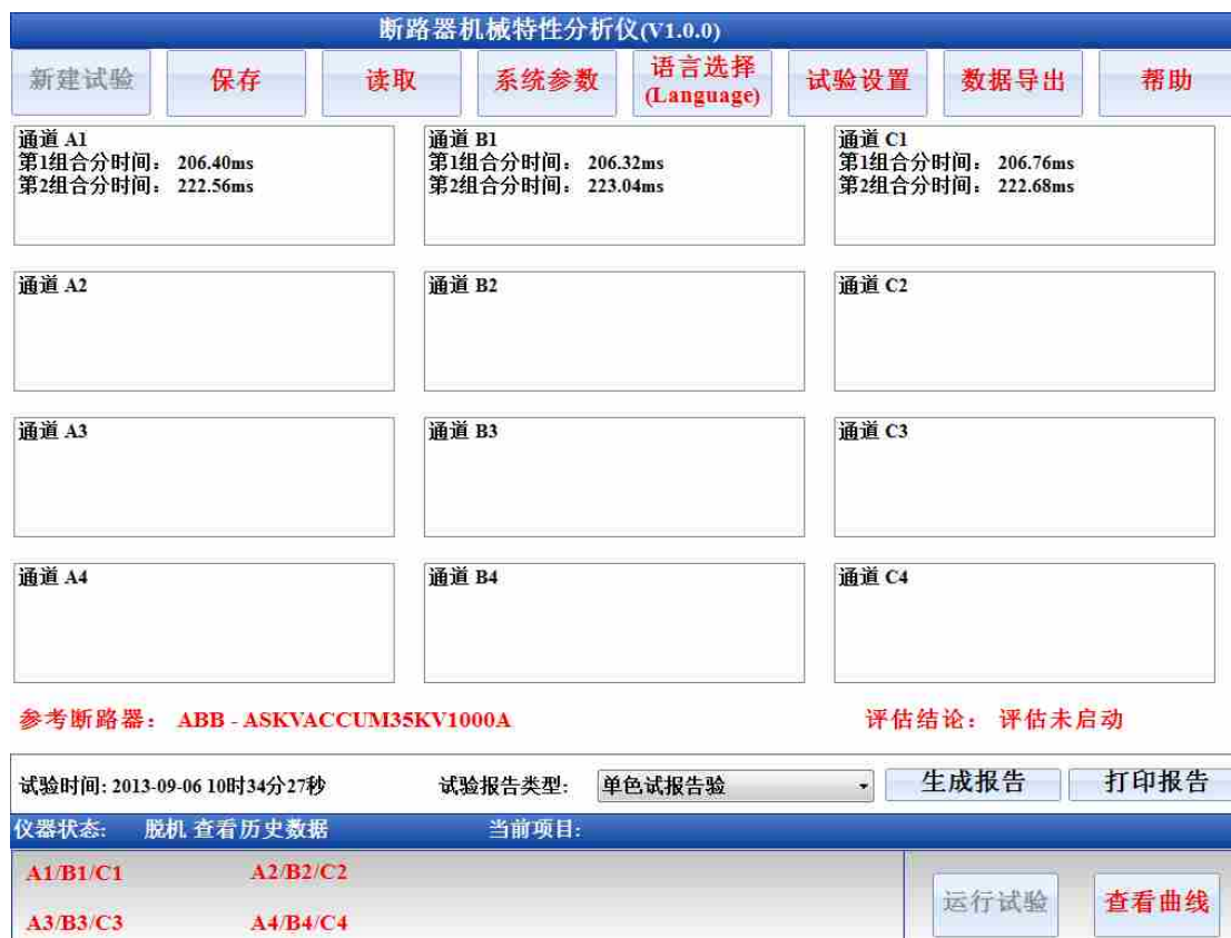
图 6.9 额定操作序列试验测试结果
