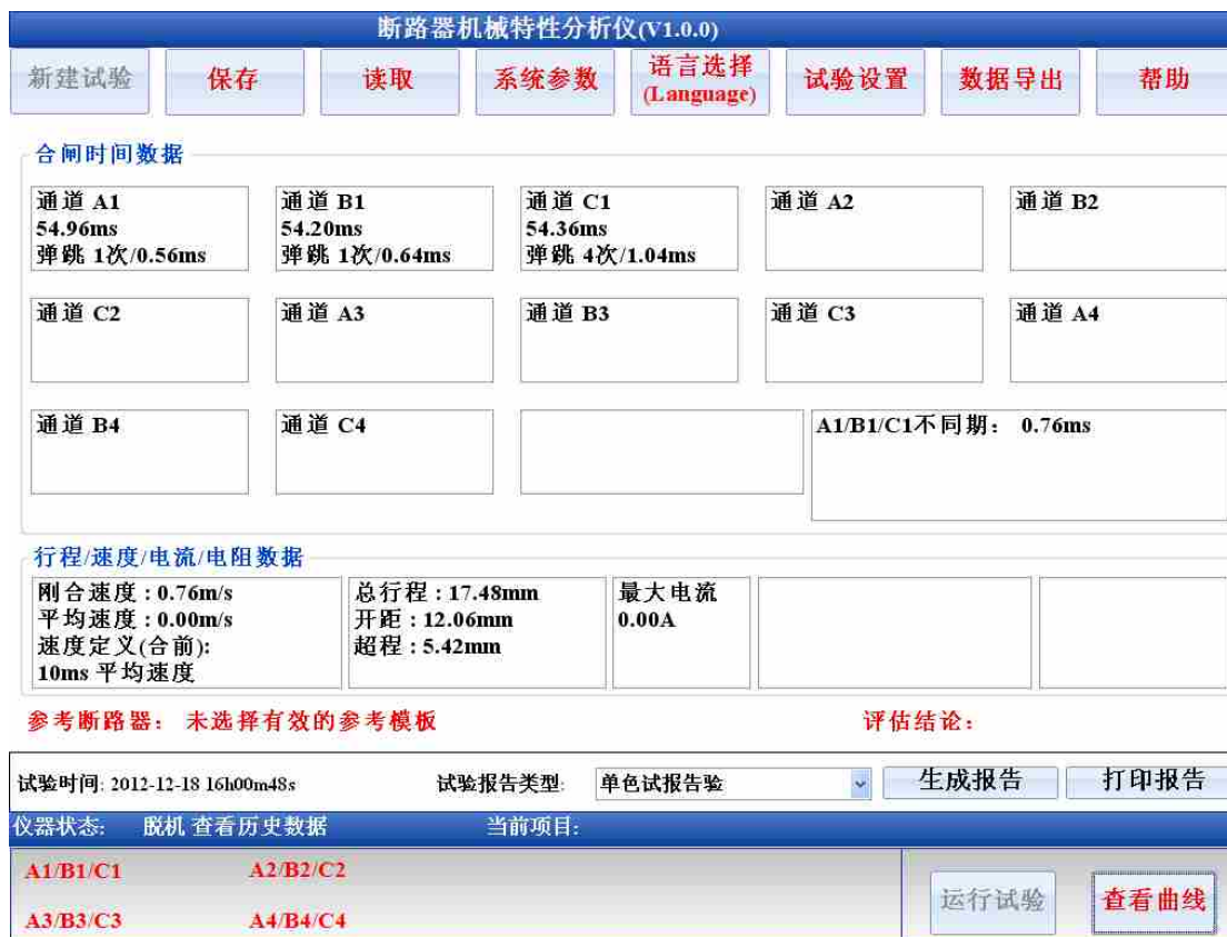
图 6.3 合闸试验测试结果
