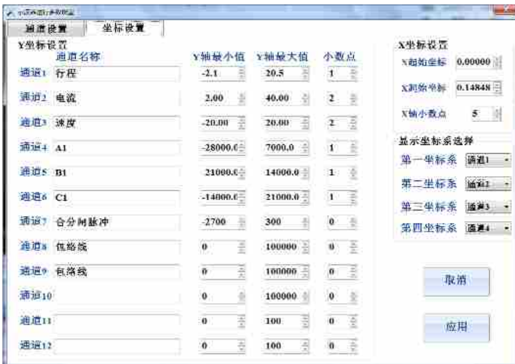
图 5.5 示波器的坐标设置
